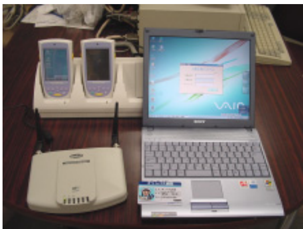
写真1：バーコード入力による介護支援システム (左上：バーコードリーダー、左下：無線アクセシブイント、右：サーバー)
